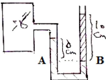
در سطح های هم تراز یک مایع، فشار برابر است. بنابراین:
